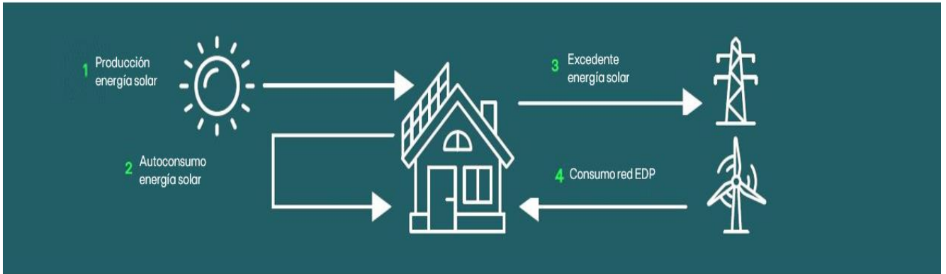
Gráfico 8. Esquema de funcionamiento de una instalación solar con autoconsumo y compensación de excedente
