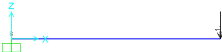
Figura 8. Viga empotrada con esfuerzo a flexión.
