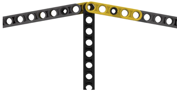
Figura 59. Desalineamiento de la unión en la cumbrera
