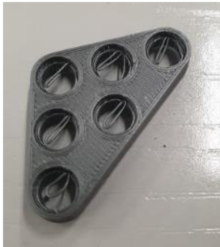
Figura 92. Cartela de hombro con material residual en los taladros.
