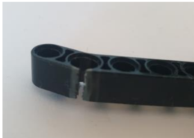
Figura 128. Detalle de la sección de rotura de la viga LEGO
