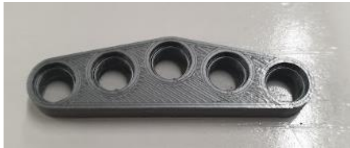
Figura 89. Cartela de cumbrera mediante fabricación aditiva.
