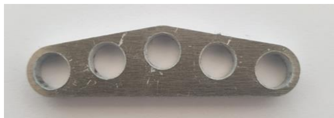
Figura 81. Cartela cumbre fabricada en aluminio.
