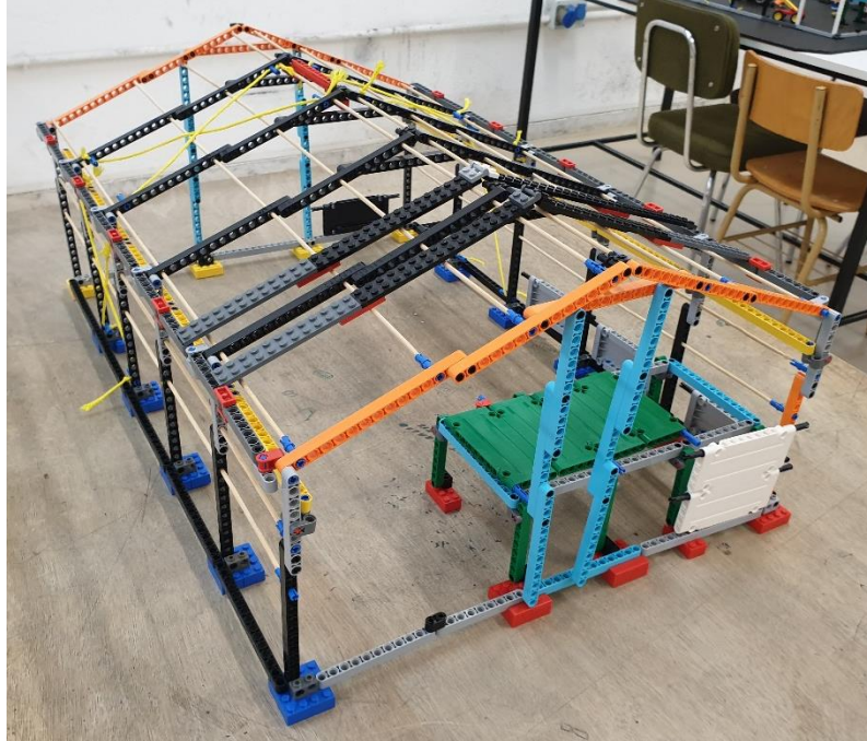
Figura 10. Nave industrial hecha mediante piezas LEGO [6]
