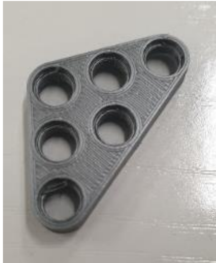
Figura 88. Cartela de hombro mediante fabricación aditiva.
