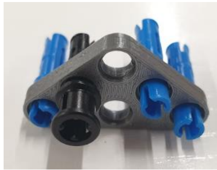
Figura 97. Pinos de conexión en la cartela del hombro.
