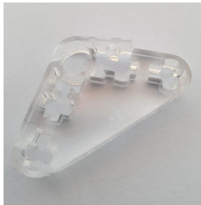
Figura 77. Cartela de metacrilato con fallo en zona superior derecha.
