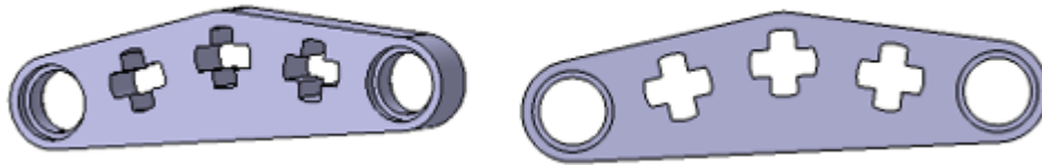
Figura 100. Diseño de la cartela cumbre con cruces.
