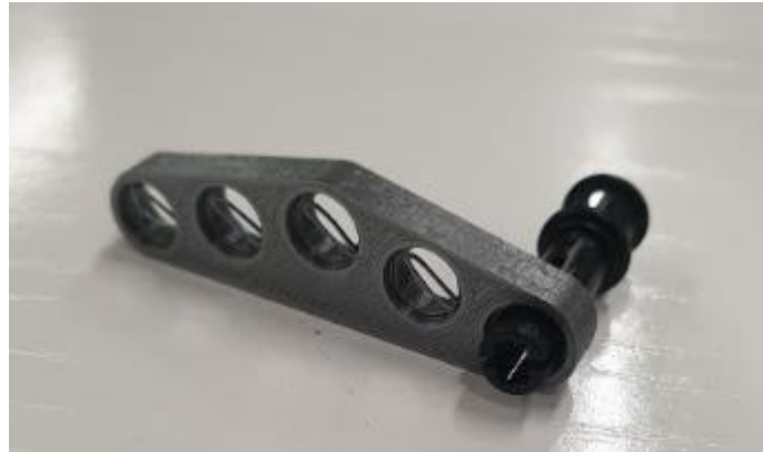
Figura 94. PIN empleado para eliminar material residual de la fabricación aditiva.
