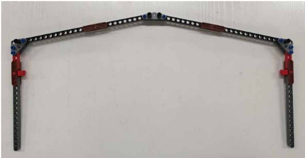
Figura 51. Pórtico sin pilares intermedios.
