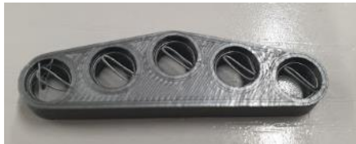
Figura 93. Cartela de cumbrera con material residual en los taladros.
