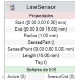
Ilustración 47. Componente inteligente. LineSensor.
