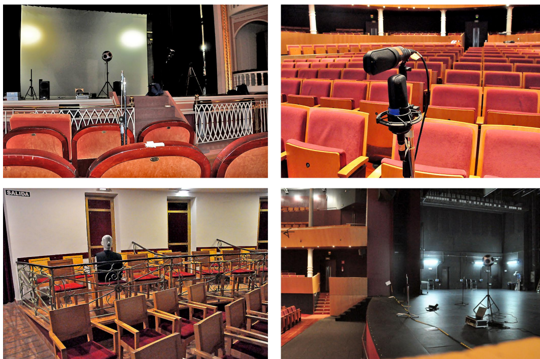
Figura 5.3: Vistas de las distintas configuraciones de medida: configuración microfónica (superior izda.), configuración pareada JLF (superior dcha.), configuración LEV (inferior izda.), configuración escenario ST (inferior dcha.).
