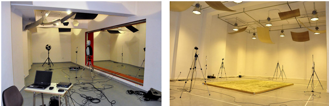
Figura 5.2: Vistas de las cámaras reverberantes utilizadas para el ajuste y validación de las magnitudes de fuerza sonora (G) y fracción de energía lateral precoz (JLF): cámara reverberante UPM (izda.) y cámara reverberante ITct (dcha.).
