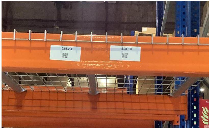
Figura 4.7 Modelo de numeración de los huecos en las estanterías del almacén
