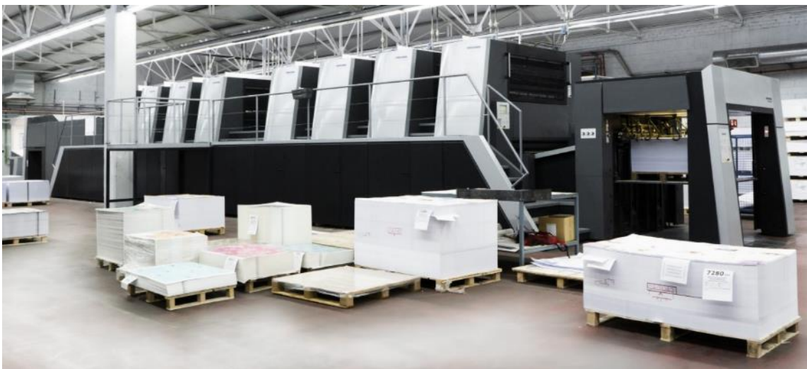
Figura 3.1 Máquina Heidelberg, perteneciente al área de impresión de Macrolibros S.A.
