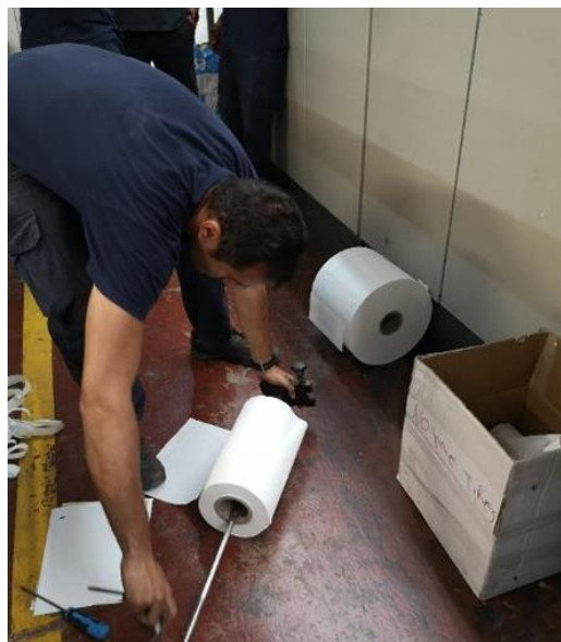
Figura 5.24 Proceso de cambio de papel en la KM. Macrolibros S.A.
