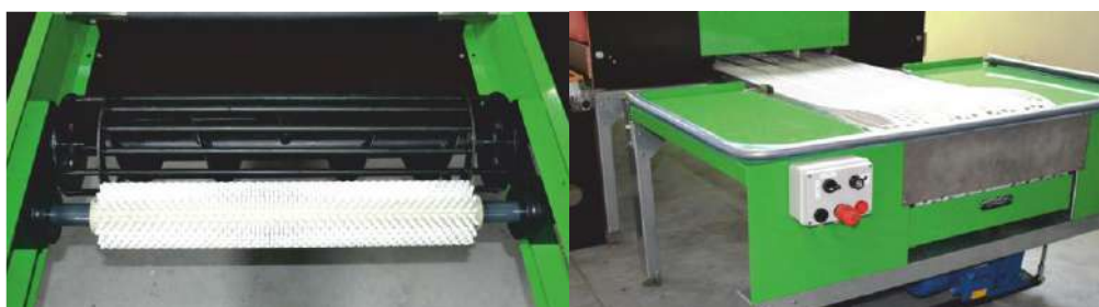
Figura 16: Izquierda: rodillos de limpieza de la cinta. Derecha: mesa de trabajo. Nótese en la parte inferior el motor con reductora. Fuente: Wesstron
