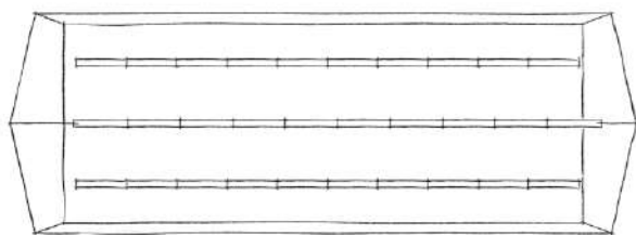
Figura 13: Ejemplo de disposición de las luminarias en la nave, en tres filas paralelas. Elaboración propia
