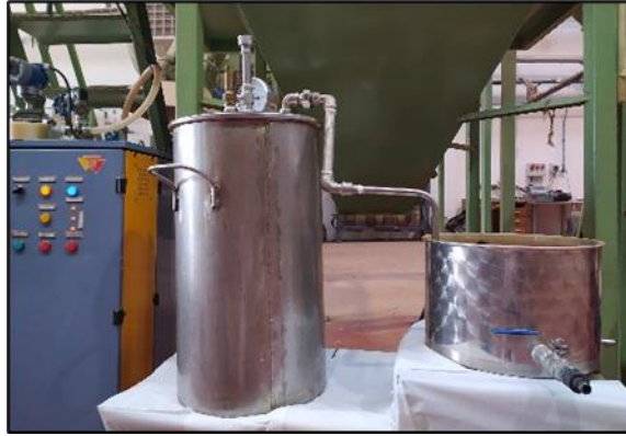
Figura 10: Destilador de 50 litros del CEDER-CIEMAT
