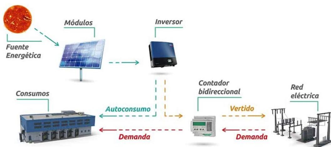
Figura 26: diagrama instalación híbrida
