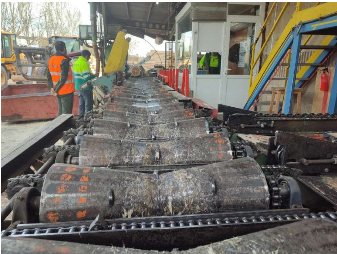
Ilustración 10: Tronzadora y rodillos que mueven las trozas
