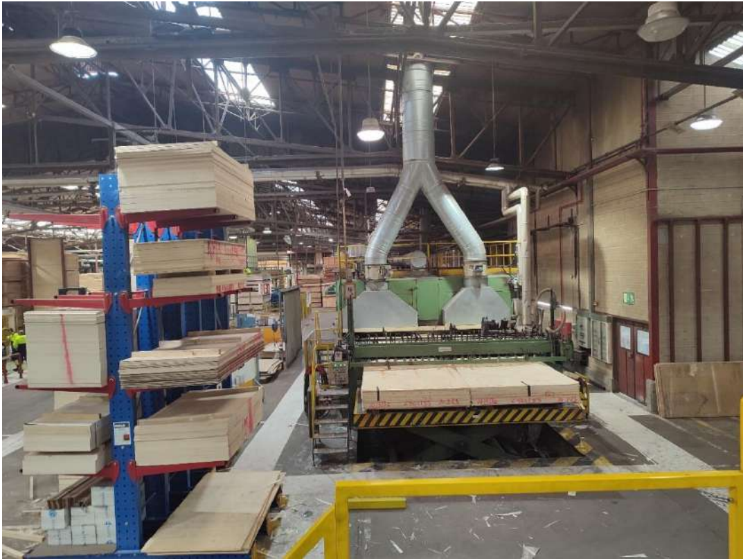
Ilustración 13: Cadena de secado de las chapas de madera
