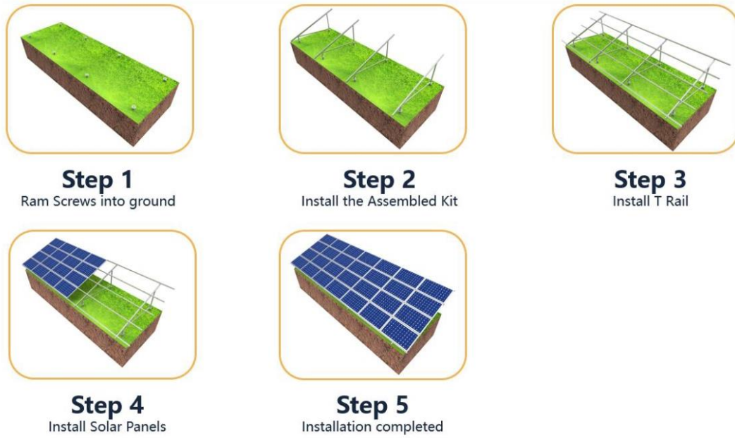
Figura 3: Pasos para instalar la estructura soporte
