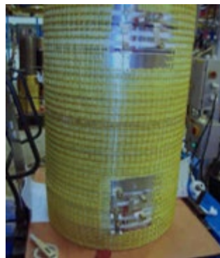
Figura 25: Bobinas en bandas de AT cubierta con malla de fibra de vidrio dispuesta para ser introducida dentro de un molde metálico en la autoclave [6]
