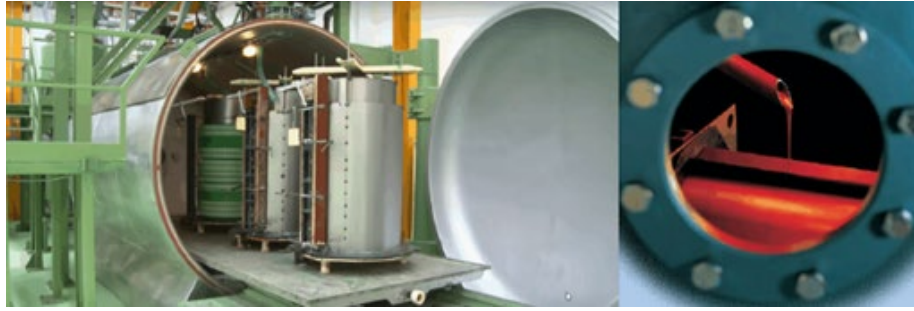
Figura 30: Autoclave y colada de resina llenando los moldes con las bobinas. [6]
