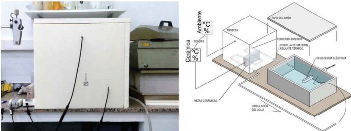
Figura 1. Probeta durante uno de los ensayos y esquema de funcionamiento.
