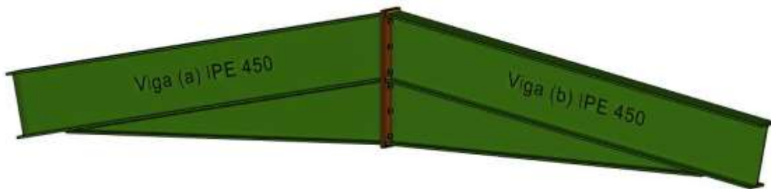
Figura 91. Modelo 3D, generado en Cype, de la unión entre los dinteles centrales.
