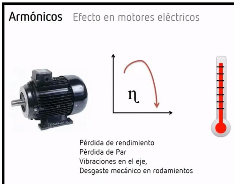
Figura 7 – Pérdidas en un motor por efecto de armónicos. Fuente: [17]
