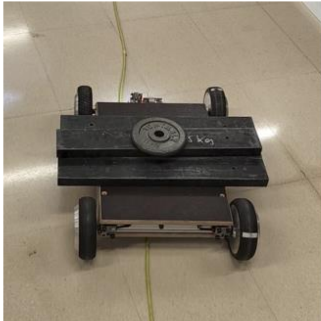
Figura 52. AGV en modo automático con 51 Kg
