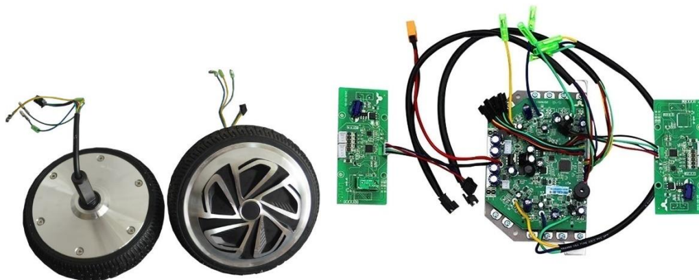
Figura 17. Motores y placas de un hoverboard. [14]
