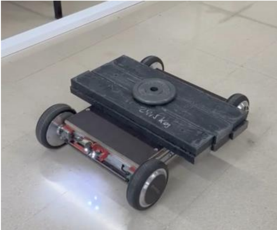
Figura 53. AGV en modo manual con 75.5 Kg
