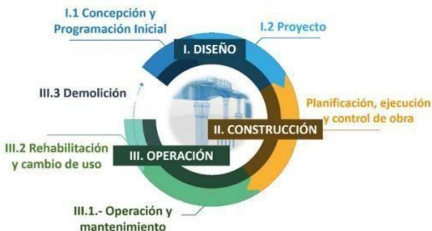
Figura 3: Etapas de un proyecto BIM en las que aparece la prevención. Fuente:[3]
