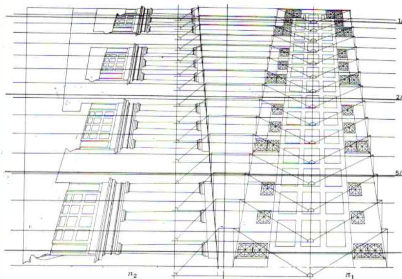
i6 R. Sinisgalli: levantamiento y restitución geométrica de la Galería Spada, con la distribución de los quince puntos de vista que regulan la deformación y la disminución perspectiva de la columnata.
