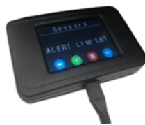
Figura 51: Pasarela de visualización Seemoto DGW ( https://www.seemoto.com/ )
