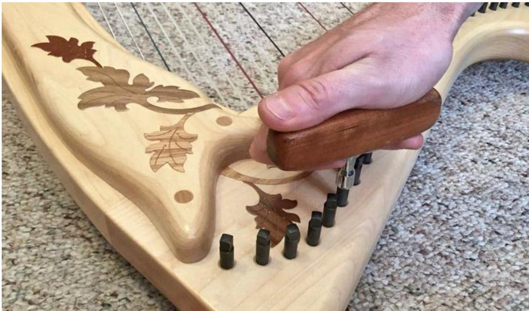
Ilustración 56. Rees Harps Inc. Ajuste de tornillos de afinación en arpa de regazo. [fotografía] EE.UU. <https://reesharps.com/slipping-lever-harp-tuning-pins>
