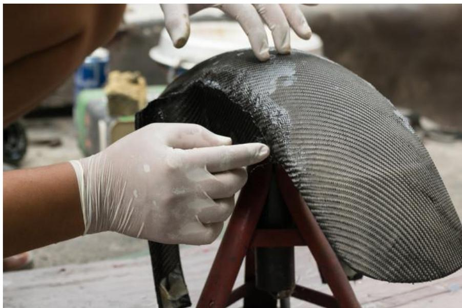
Ilustración 67. Wright, I. (2016) Fabricación manual de pieza con lámina de fibra de carbono. [fotografía] <https://www.engineering.com/story/unlocking-carbon-fibers-potential-in-manufacturing>
