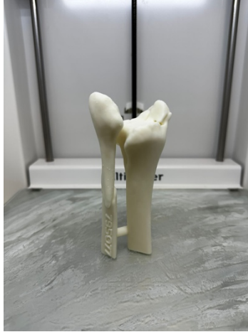
Figura 2. Modificación de la estructura original de tibia y peroné por medio de la incorporación en la fase de procesado de un cilindro en la base para mantenerlos unidos, así como del número de historia del paciente.
