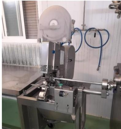
Fig. 49. Grapadora junto a la embutidora. [13]
