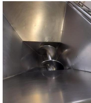
Fig. 46. Tornillo sin-fin y tolva de la picadora. [13]
