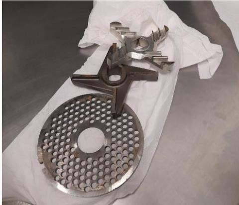
Fig. 47. Cuchillas picadora. [13]
