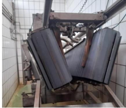
Fig. 16. Restraîner y pinza de descarga eléctrica. [11]
