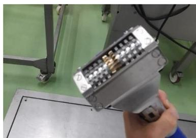
Fig. 25. Peladora neumática. [12]
