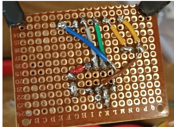
Figura 25: Circuito pruebas AI, conexiones inferiores
