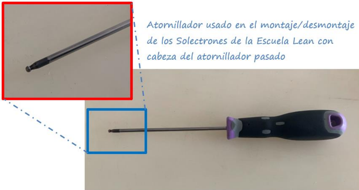
Ilustración 44. Causa constatada deterioro de la cabeza del atornillador.
