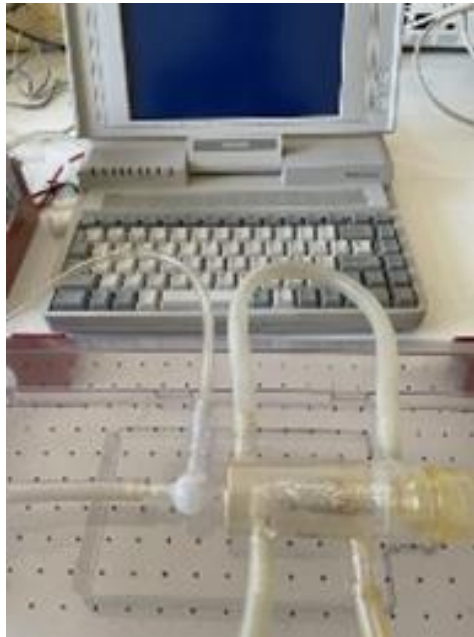
Fig. 1. Dispositivo de evaluación de la coaptabilidad de la endoprótesis
