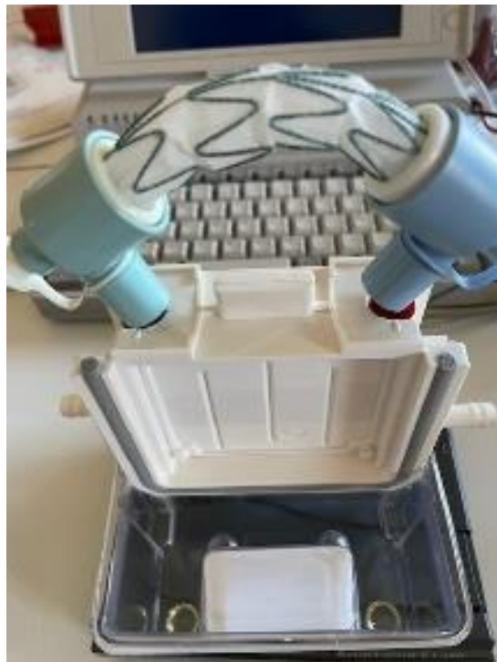
Fig. 4. Modelo mecánico utilizado para evaluar la flexibilidad del dispositivo
