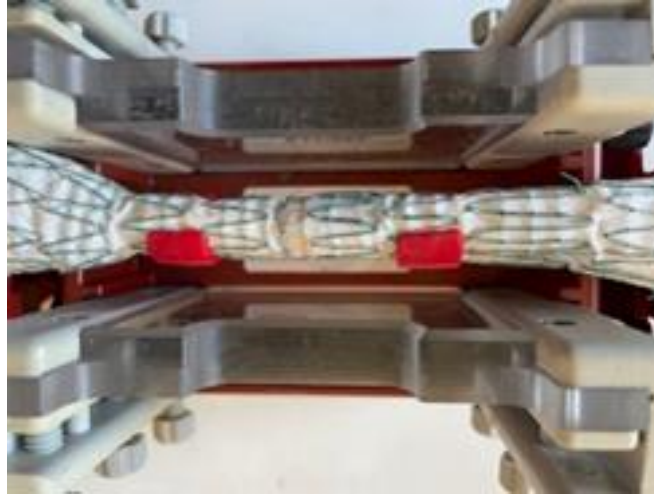
Fig. 3. Aparato con el que se realizó la comprobación de la estabilidad del acoplamiento
