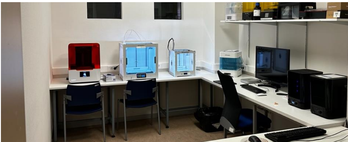
Figura 6. Impresoras FDM y SLA disponibles en el Hospital Universitario del Río Hortega.
