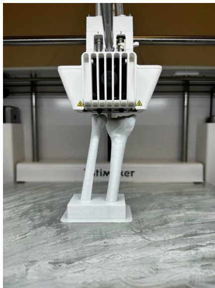
Figura 3. Realización de modificaciones en la estructura cubito-radial distal gracias a la adición de un prisma en la fase de procesamiento en la base para que permanezcan pegados.
