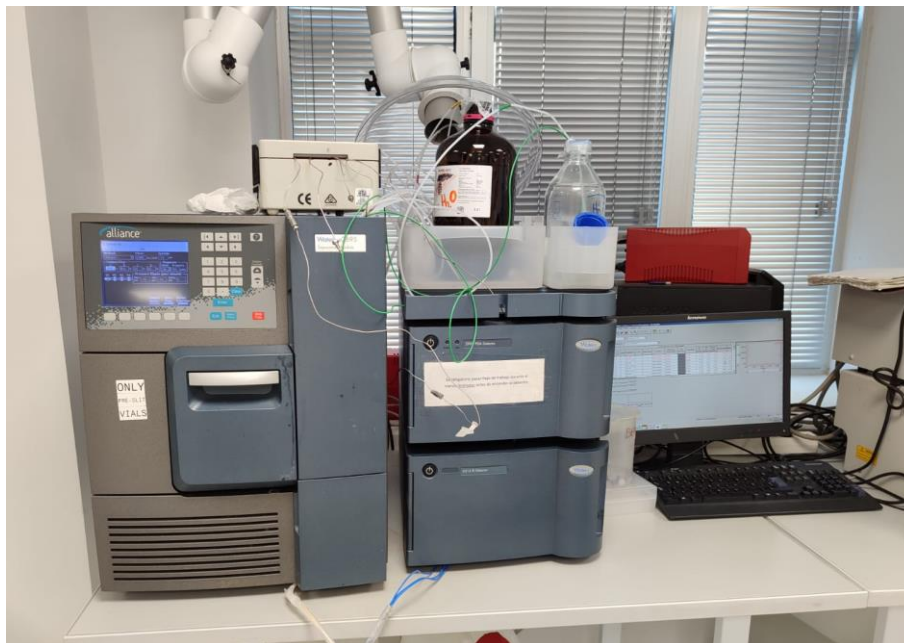
Figura 20: HPLC para el análisis de ectoína
