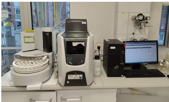
Figura 18: Instrumento para analizar TOC e IC
