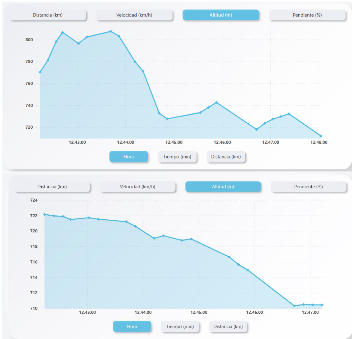
Figura 69. Comparativa entre el perfil de altitud obtenido utilizando el localizador GPS (arriba) y utilizando valores reales (abajo) (elaboración propia)
