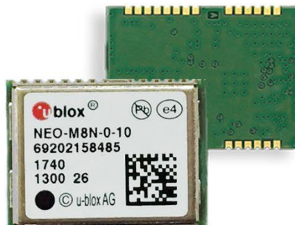
Figura 23. Chip GPS NEO-M8N (extraído de [39])
