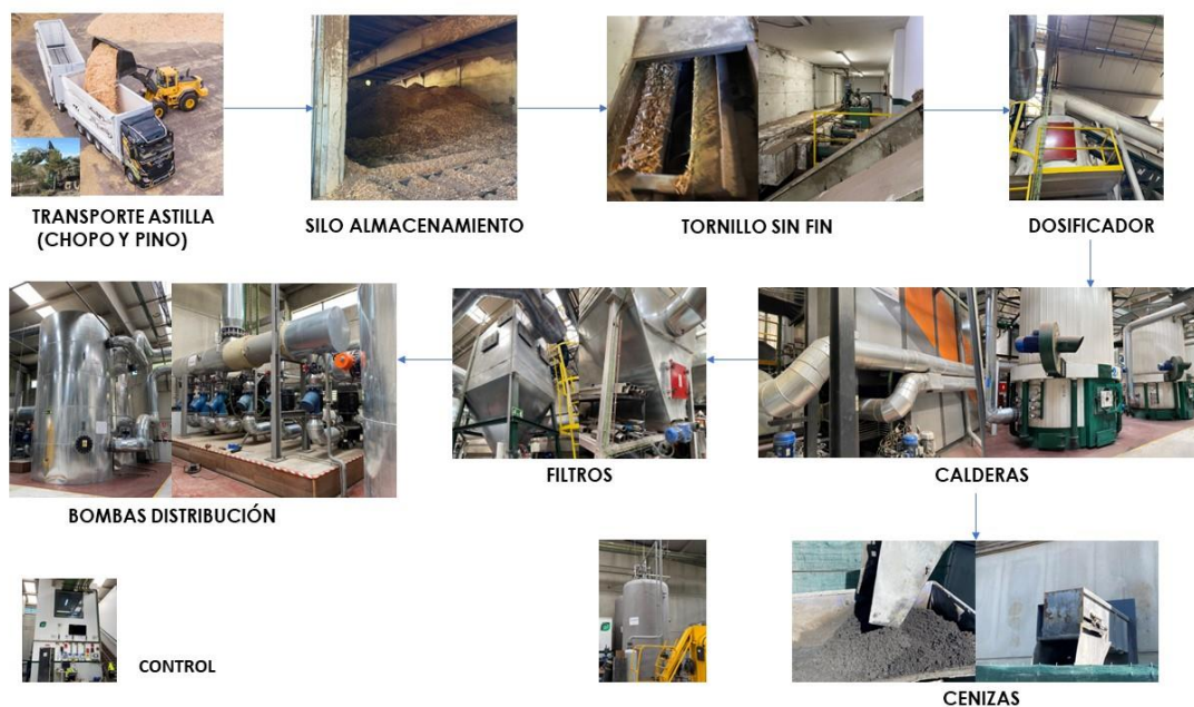
Ilustración 18. Esquema funcionamiento central biomasa UVA. Fuente: Elaboración propia.
