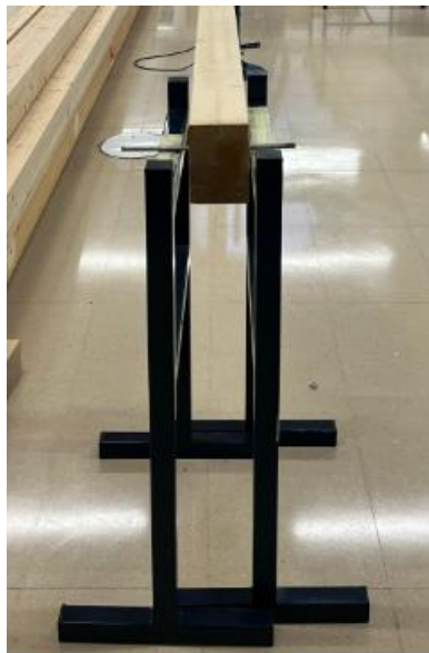
Figura 15. Detalle apoyo extremo viga con dos caballetes
