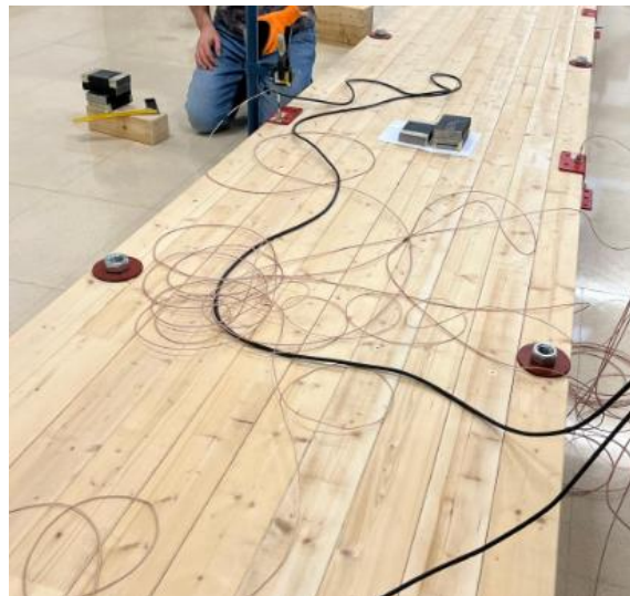
Figura 71. Detalle ensayo estático para la plataforma de nueva construcción
