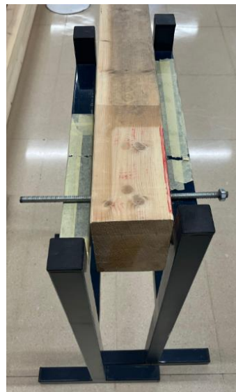
Figura 35. Detalle 2 método de apoyo en ensayos vigas
