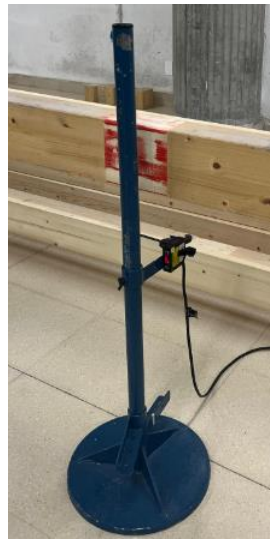
Figura 36. Detalle colocación láser plataforma nueva
