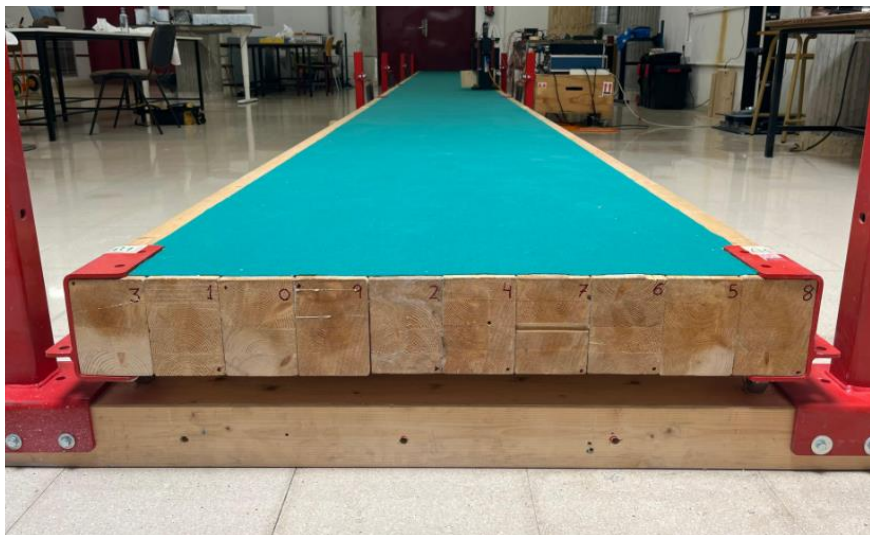
Figura 65. Colocación vigas en la nueva plataforma
