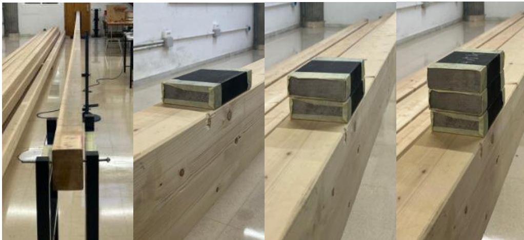
Figura 59. Detalle ensayo estático para una viga
