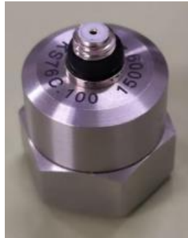
Figura 16. Detalle acelerómetro para obtener modos
