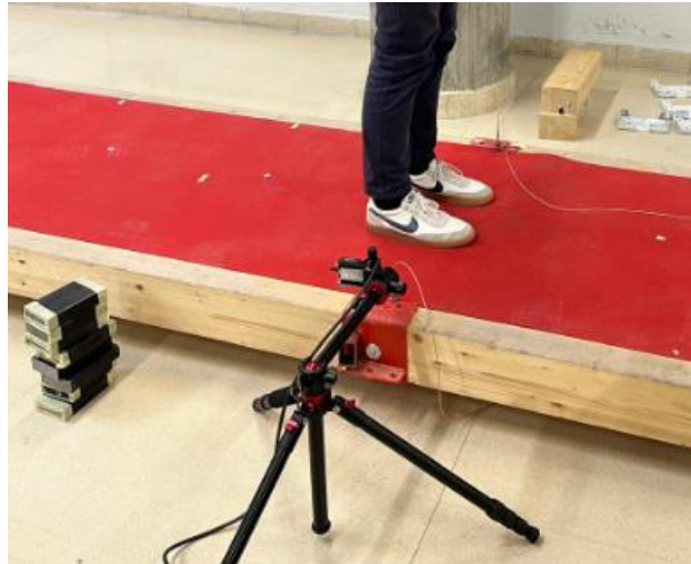
Figura 68. Detalle ensayo carga con persona
