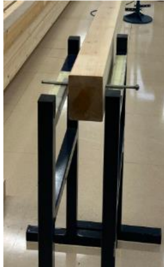
Figura 34. Detalle 1 método de apoyo en ensayos vigas
