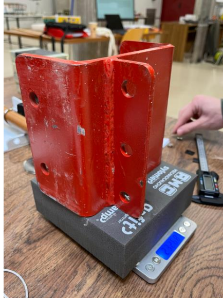
Figura 14. Detalle procedimiento de pesaje de grapa
