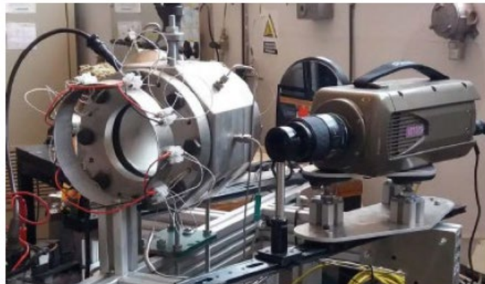
Figura 2.3: Instalación de la bomba cilíndrica a volumen constante y la cámara de alta velocidad [5].
