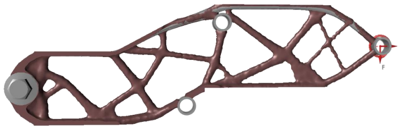
Figura 28. Pieza guía para el modelo CAD de la unidad funcional (Ejemplo de Inspire 2023.1)
