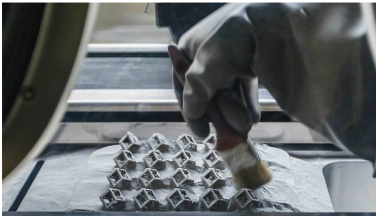
Figura 16. Posprocesado de piezas realizadas por LPBF [21]
