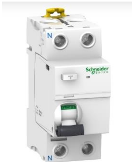
Ilustración 13: Interruptor diferencial IID 2P 25A 30 mA (fuente: [36])
