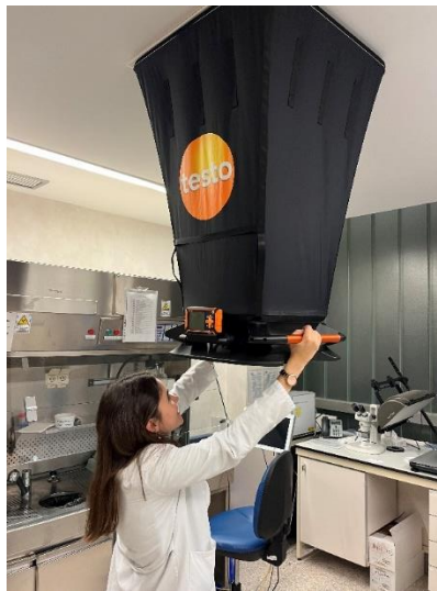
Figura 28. Medición con balómetro Testo 420.
