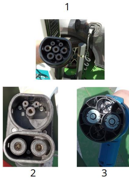
Figura 4-Tipos de cargadores de VE: 1-Tipo Mennekes, 2-Tipo COMBO, 3-Tipo CHADEMO. Fuente: Elaboración propia
