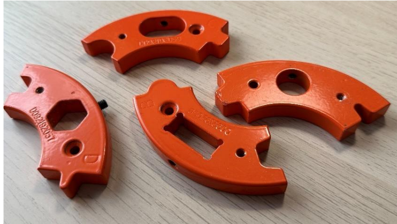
Ilustración 14. Sectores con orificios para Insertos. (Elaboración propia)
