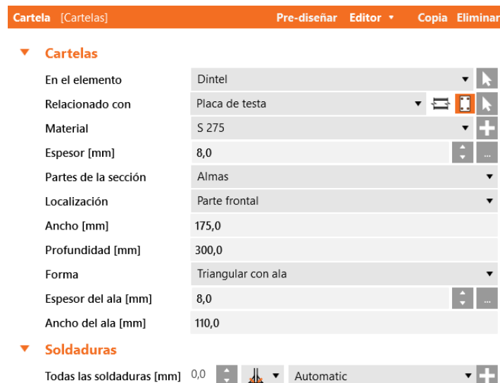
Figura 37: Parámetros de creación de la cartela con IPE300
