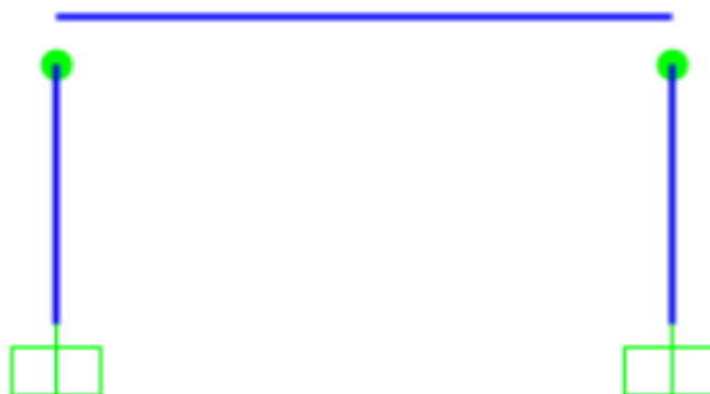
Figura 16: Pórtico articulado con rótulas en los pilares
