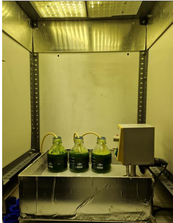
Figura 13. Reactores empleados en el tratamiento biológico.
