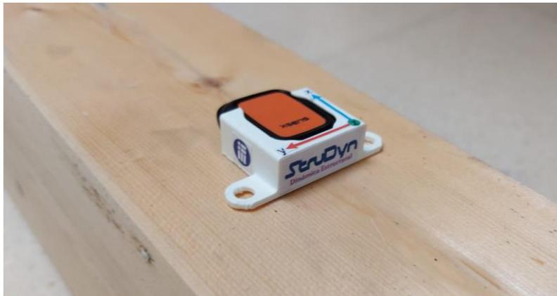
*Figura 20. Foto de la colocación de los IMUs en la viga.*
