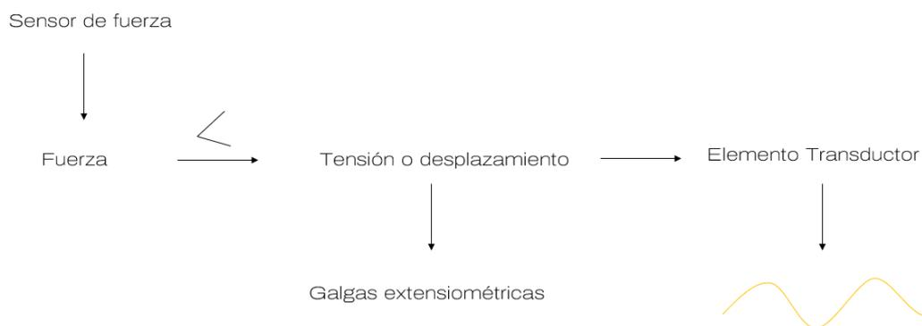
*Figura 2. Esquema resumen del principio de funcionamiento.*
