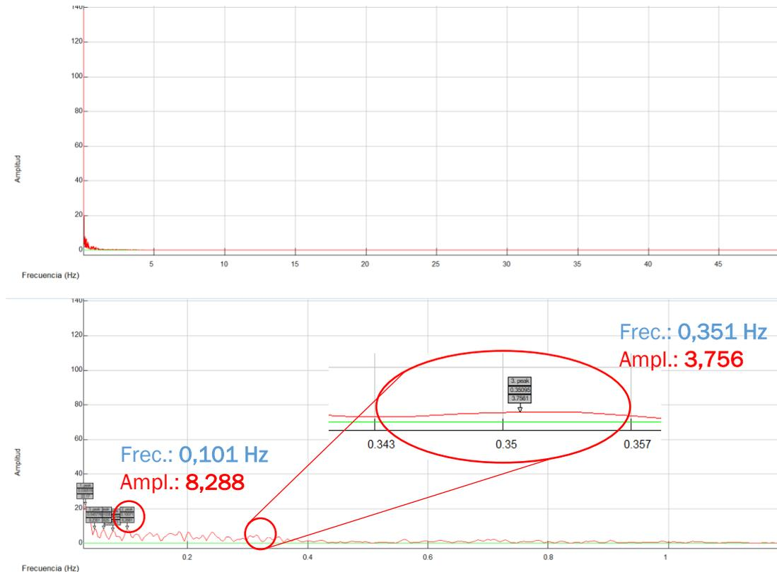
Figura 60. Gráfica frecuencial de las cargas de Álvaro, arriba rango completo, abajo rango aumentado para observar los máximos.
