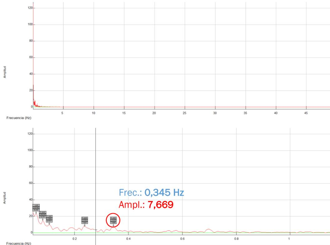
*Figura 62. Gráfica frecuencial de las cargas del Saúl, arriba rango completo, abajo rango aumentado para observar los máximos.*
