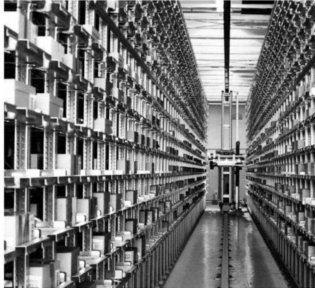
Figura 17. Estantería "mini-load" con transelevador automático
