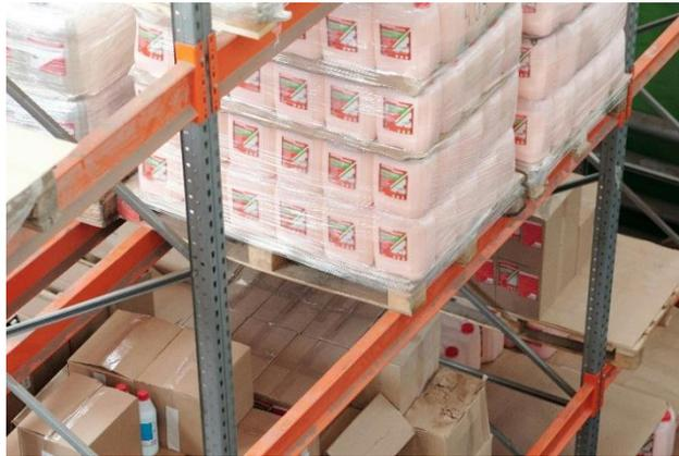
Figura 15. Palé situado longitudinalmente
