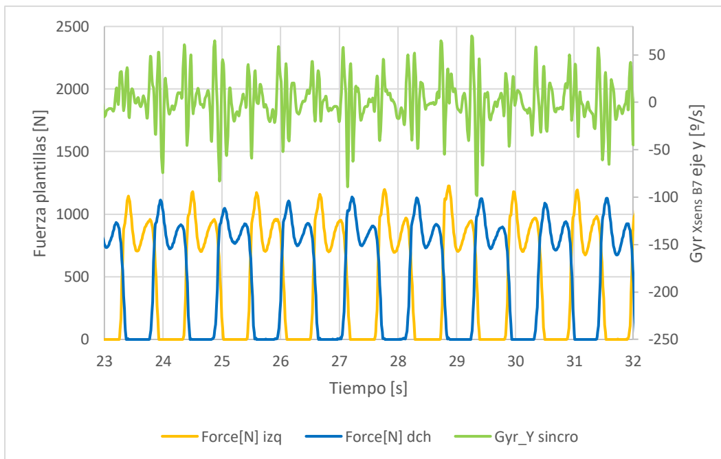
Figura 49. Fuerza de las plantillas y velocidad angular del eje y frente al tiempo.
