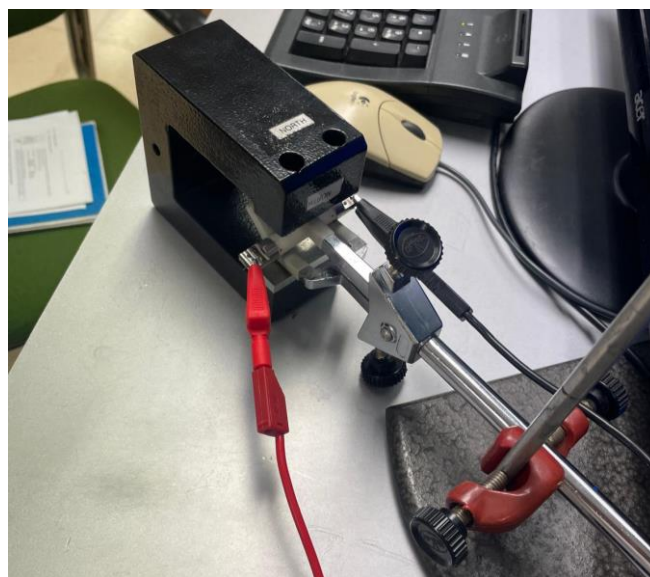
Ilustración 46. Conexión eléctrica del sensor de hilo vibrante
