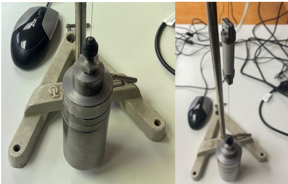
Ilustración 44. Peso colgante para el tensionado del hilo
