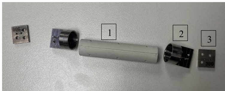
Ilustración 42. Partes del sensor de hilo vibrante
