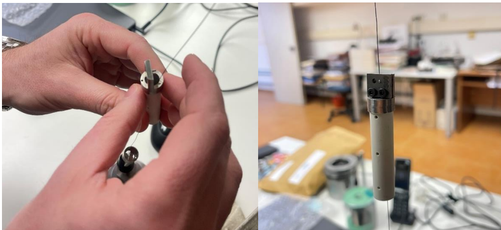
Ilustración 43. Ensamblaje del sensor de hilo vibrante
