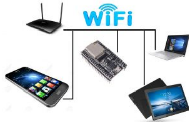
Ilustración 15. Modo estación Wi-Fi. [23]
