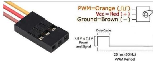
Figura 144 Servomotor MG995. Conexiones.
