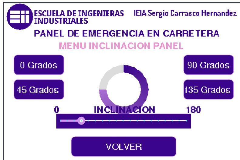
Figura 174 Pantalla del submenú de inclinación del panel LED.
