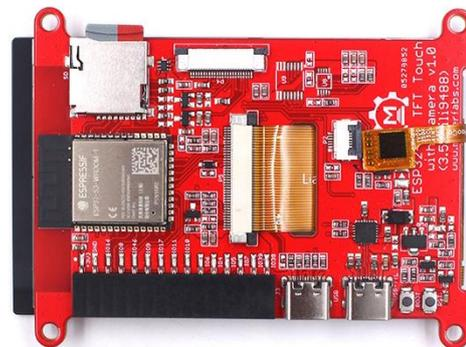
Figura 212 ESP32-S3 SPI TFT con sensor táctil – Vista frontal. Figura 213 ESP32-S3 SPI TFT con sensor táctil – Vista trasera.
