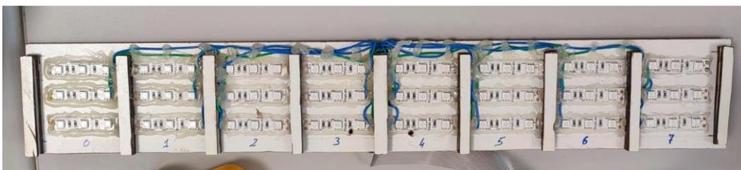
*Figura 2 Interior panel simple de ocho módulos.*
