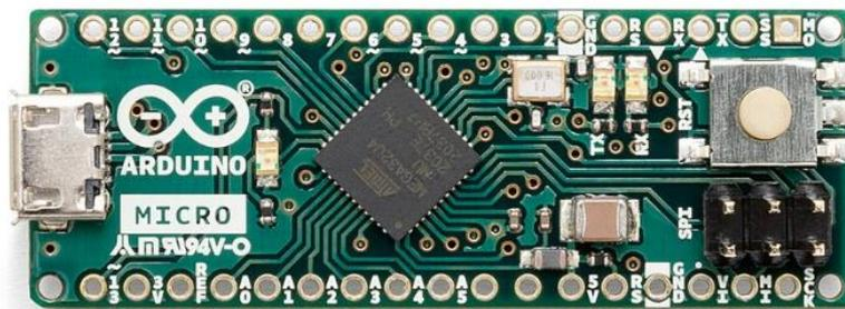
Figura 86 Arduino Micro – ATmega32U4. Vista Frontal.
