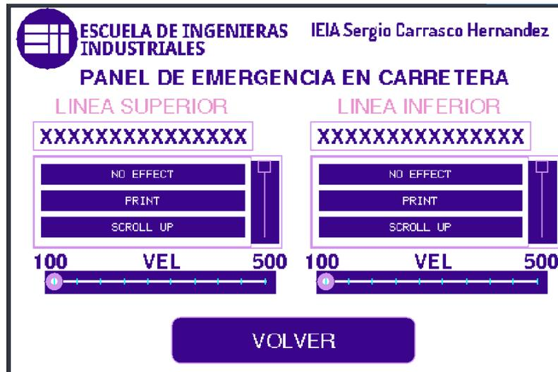
Figura 177 Pantalla del submenú de mensajes personalizados en dos filas distintas.
