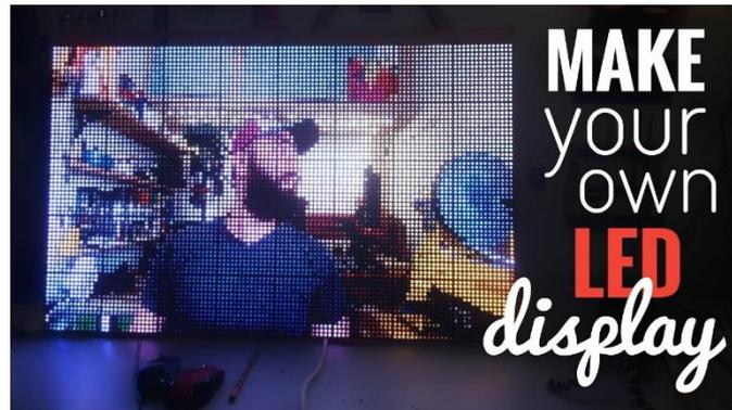
Figura 211 Pantalla formada por WS2812B.
