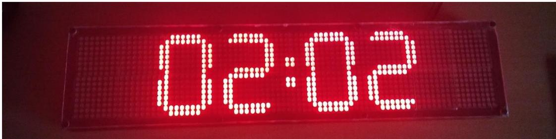
Figura 154 Reloj de doble altura con tipo de hardware FC16\_HW.
