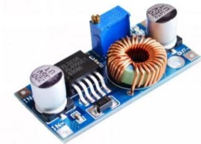
Figura 147 Placa con Buck DC-DC de 5A basado en XL4005.
