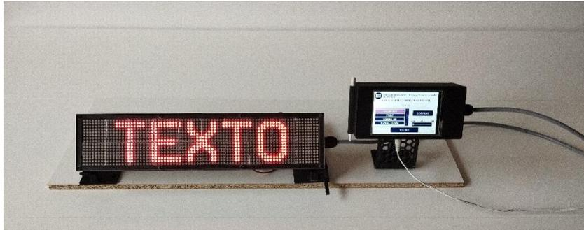
Figura 204 Montaje final del panel de emergencia en carretera - Vista frontal.
