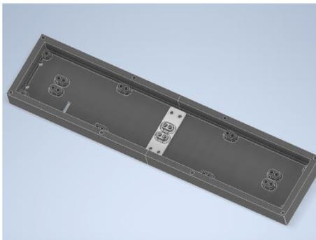
Figura 193 Diseño de la envolvente del panel LED.
