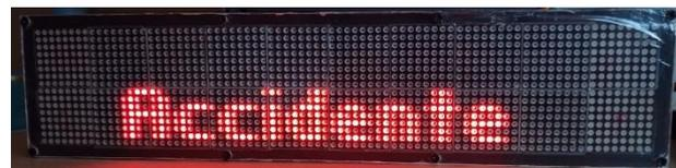
Figura 168 Fuente en panel LED con simple altura
