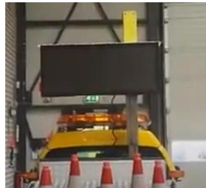
Figura 18 Panel de mensaje variable LED hidráulico - TECNIVAL. Vista del panel desplegado.
