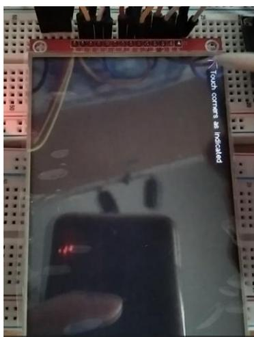
Figura 162 Prueba 1 función táctil de la pantalla TFT.
