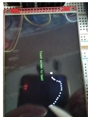
Figura 164 Prueba 3 función táctil de la pantalla TFT.
