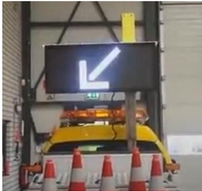
Figura 19 Panel de mensaje variable LED hidráulico - TECNIVIAL. Señalización desvío carril izquierdo.
