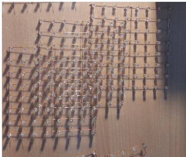
Figura 210 Matriz de 8x8 LEDs de 5mm espaciados 1,5cm.
