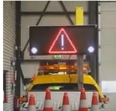
Figura 20 Panel de mensaje variable LED hidráulico - TECNIVIAL. Señal de advertencia.
