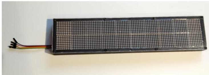
Figura 197 Envoltorio del panel LED completo.
