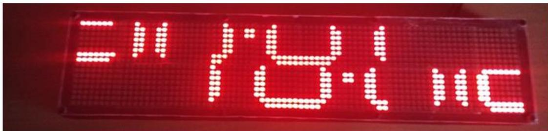
Figura 155 Reloj de doble altura con tipo de hardware: PAROLA\_HW.
