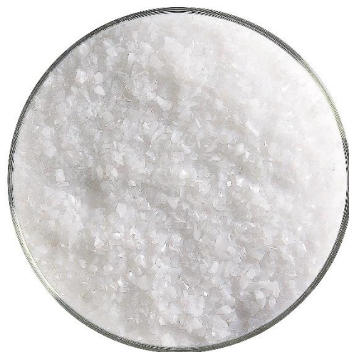
Ilustración 84. Fritas de vidrio opalino blanco de granulado medio.
