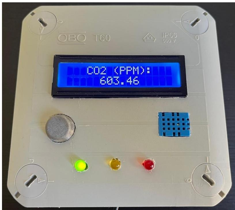
Ilustración 70. Módulo medidor con buena CAI: valores de CO<sub>2</sub>
