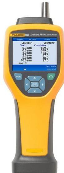
Ilustración 12. Medidor de partículas Fluke 985
