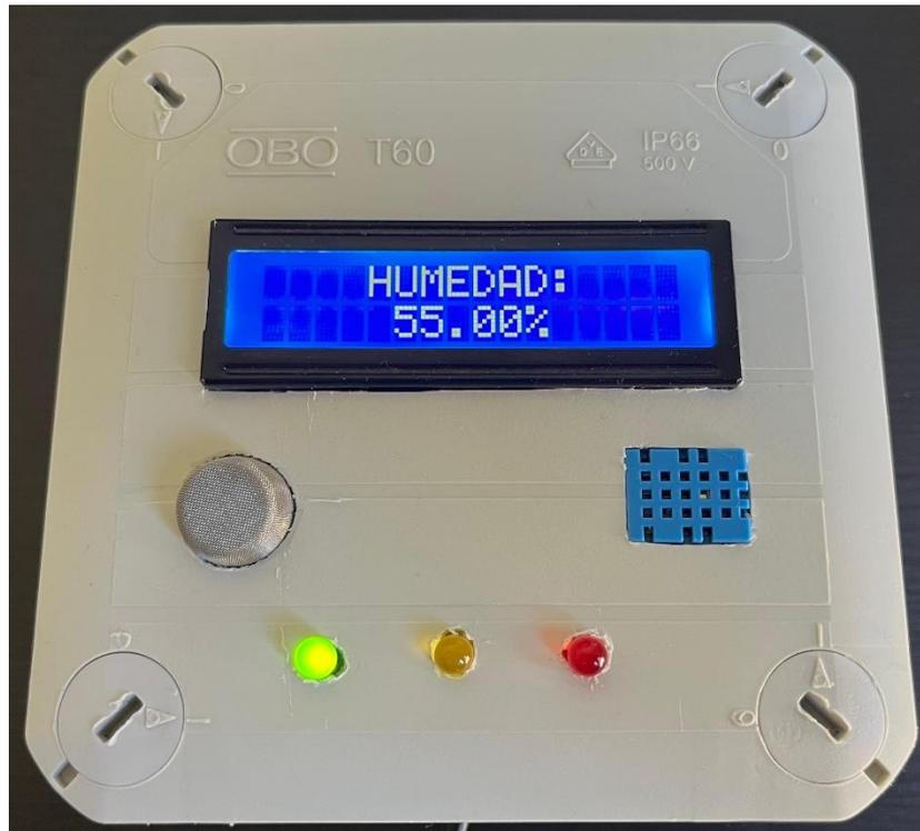
Ilustración 71. Módulo medidor con buena CAI: valores de humedad
