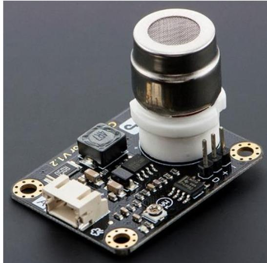
Ilustración 29. Sensor de CO<sub>2</sub> MG-811
