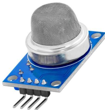
Ilustración 23. Sensor de gas MQ-135
