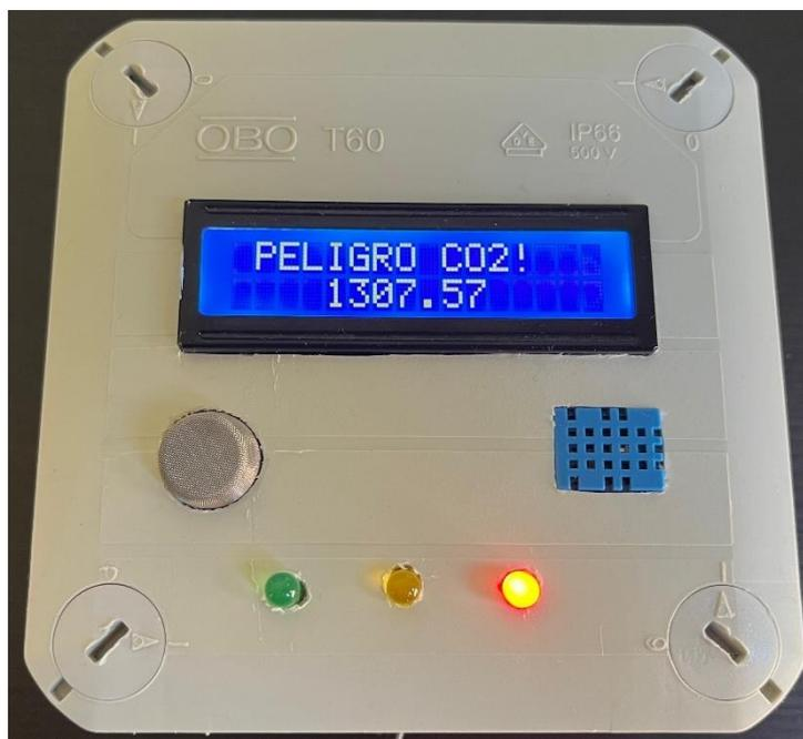
Ilustración 76. Módulo medidor con mala CAI: mensaje ¡Peligro CO<sub>2</sub>!
