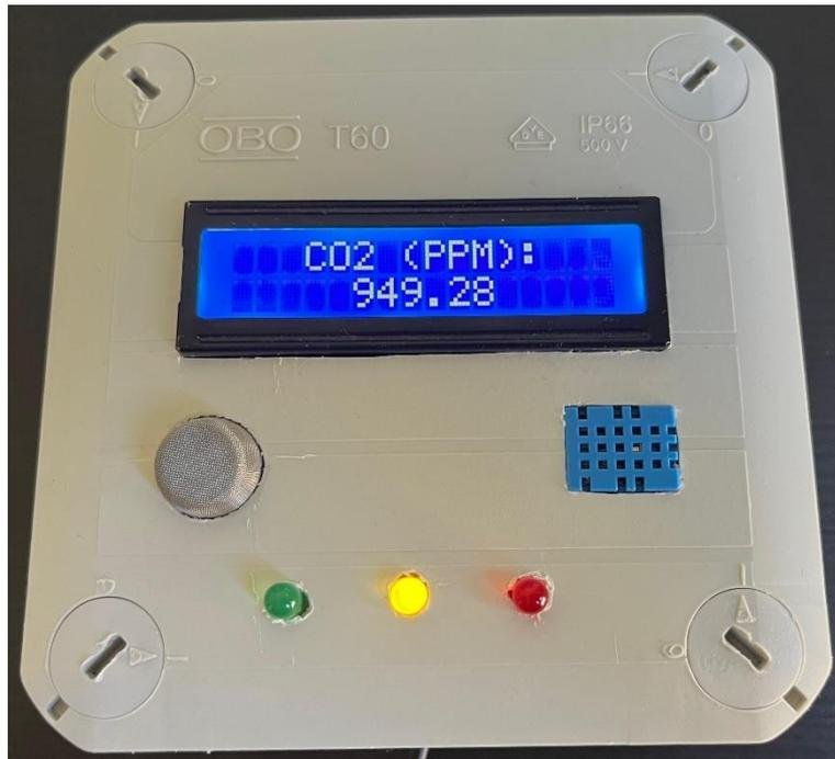
Ilustración 74. Módulo medidor con CAI preocupante: valores de CO<sub>2</sub>
