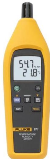
Ilustración 6. Medidor temperatura y humedad Fluke 971
