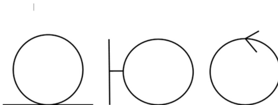
Figura 4.4: Estereotipos usados en un diagrama de secuencia. De izquierda a derecha: entidad, límite y control.
