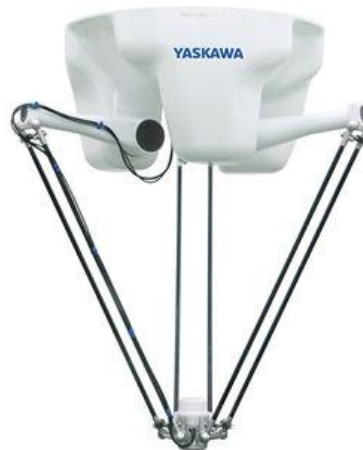
Figura 6. Robot Delta o paralelo [9]
