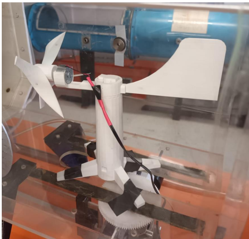
Figura 77. Aerogenerador en túnel (vista trasera).
